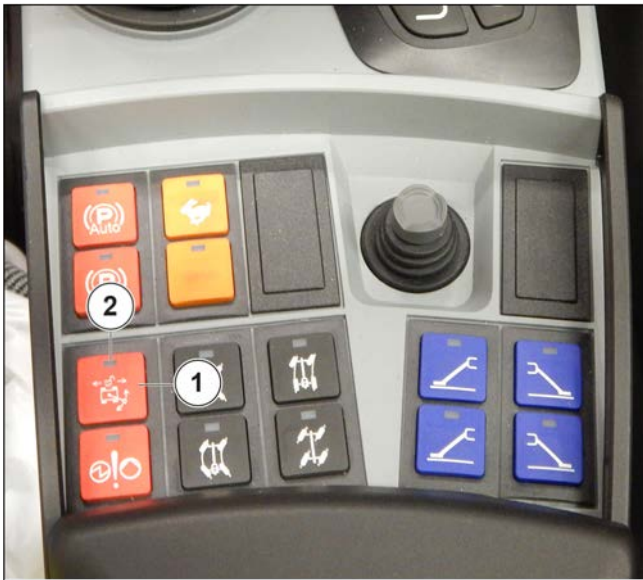
Figura 130: Buton de resetare a sistemului de siguranță a călătoriei
