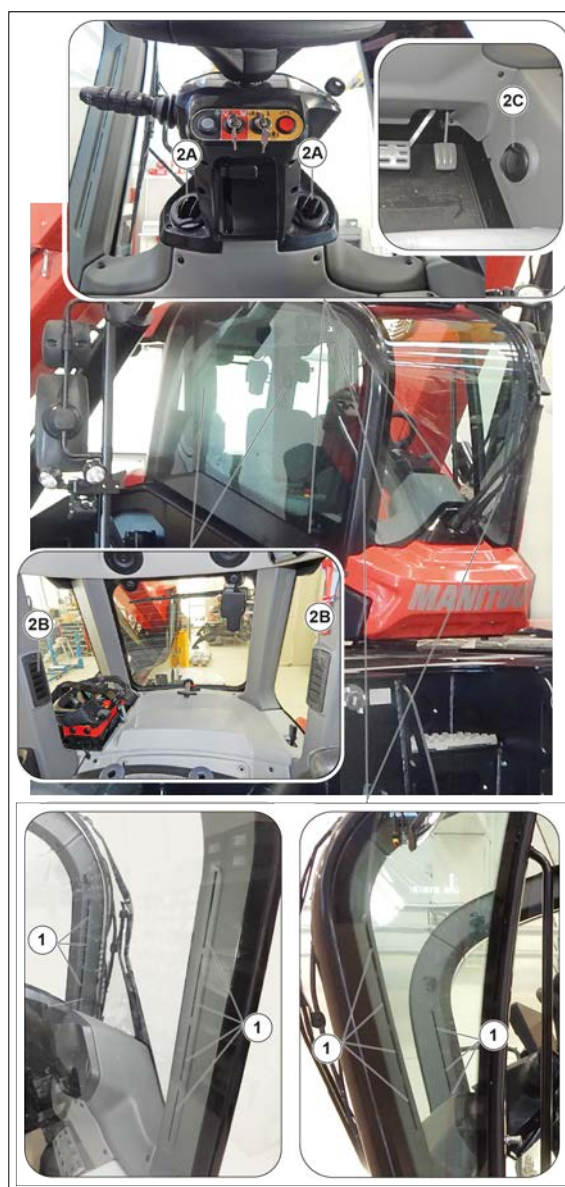
Figura 61: Difuzoare pentru dezaburire și orificii de ventilație pentru încălzire
