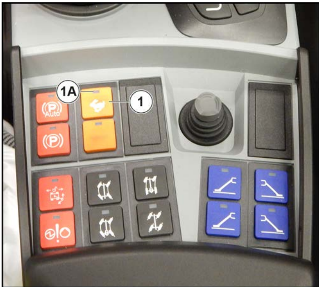
Figura 127: Selector manual de schimbare a vitezei
