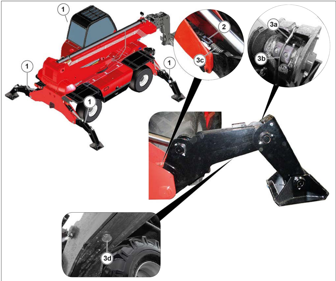
Figura 192: Înlocuirea componentelor interne ale stabilizatorului
