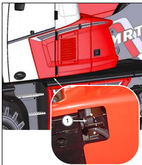
Figura 60: Maneta de eliberare a geamului ușii din afara cabinei
