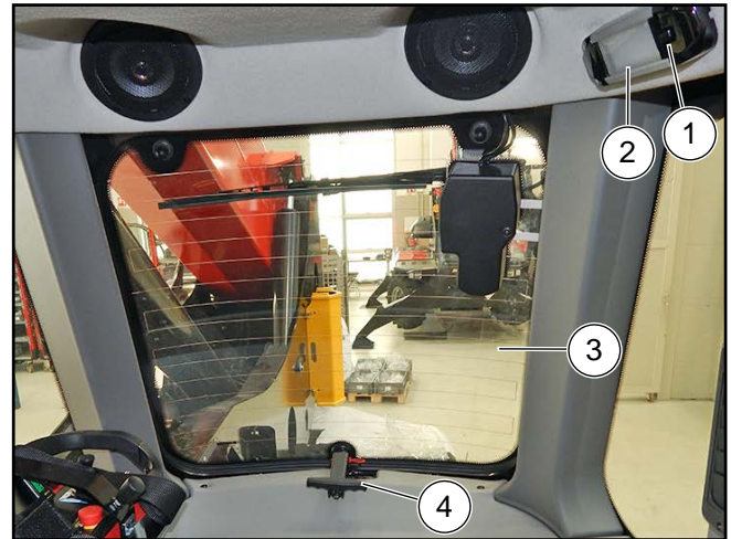
Figura 57: Lumina plafonului și manetă de deschidere a lunetei
