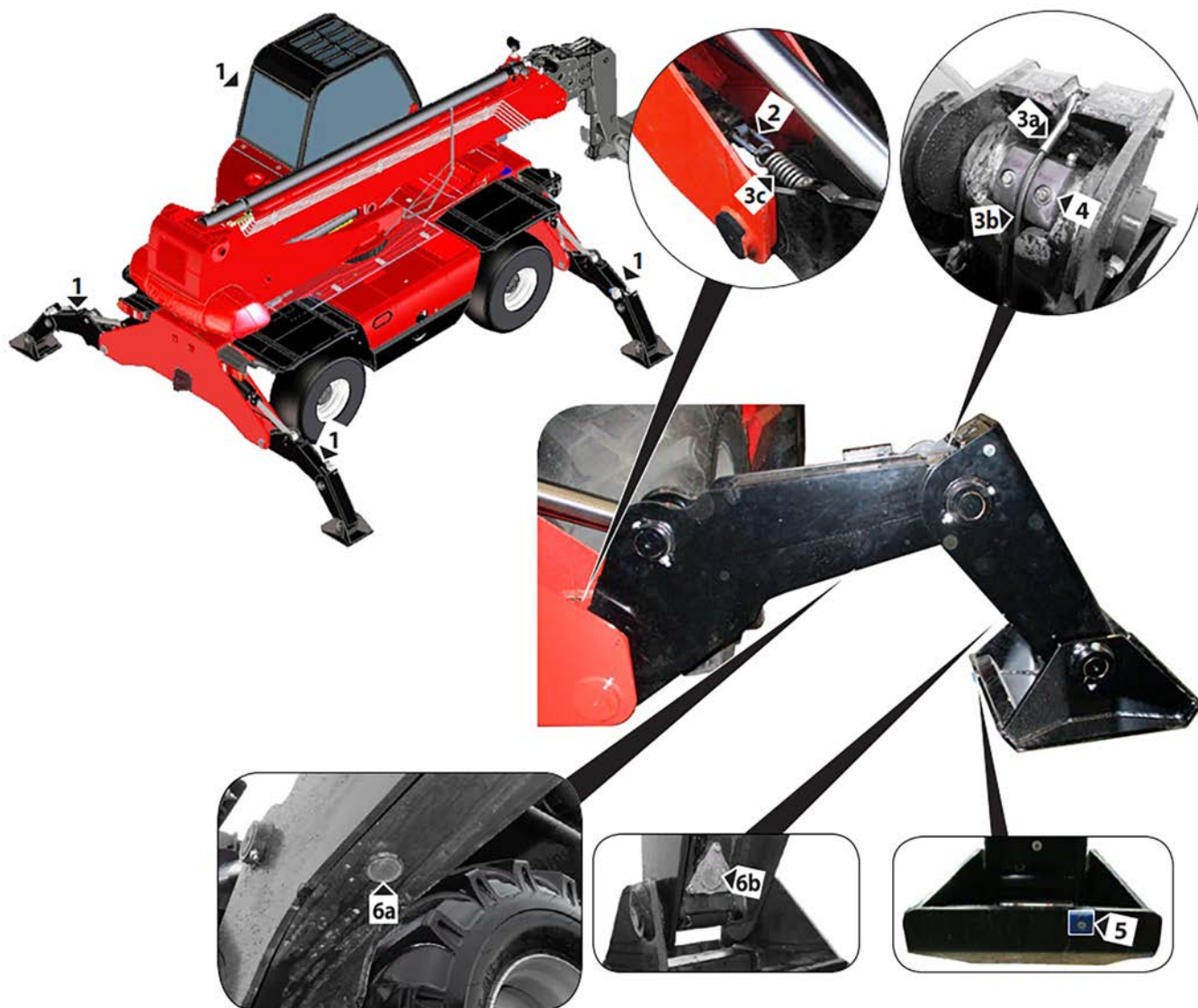
Figura 164: Verificarea sistemului de coborâre și de ridicare a stabilizatoarelor
