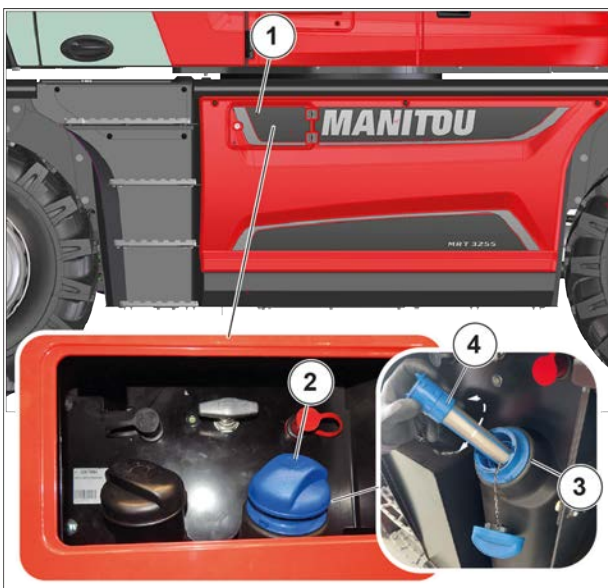
Figure 209: Verificarea și curățarea filtrului de umplere a rezervorului def
