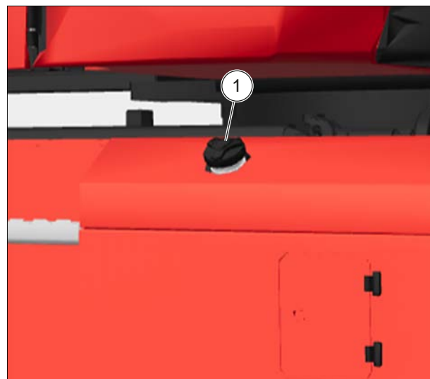
Figura 117: Umplerea rezervorului de combustibil
