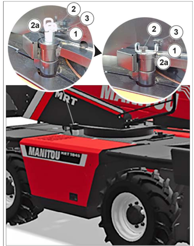
Figura 134: Blocarea rotației turelei
