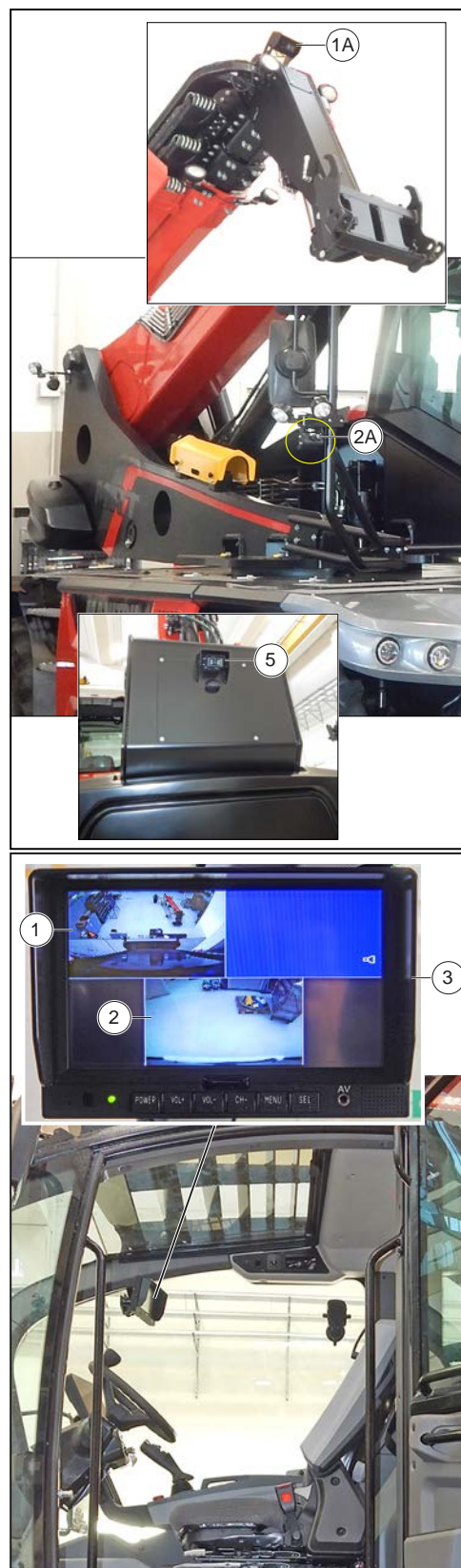
Figura 115: Sistem de cameră frontală și laterală
