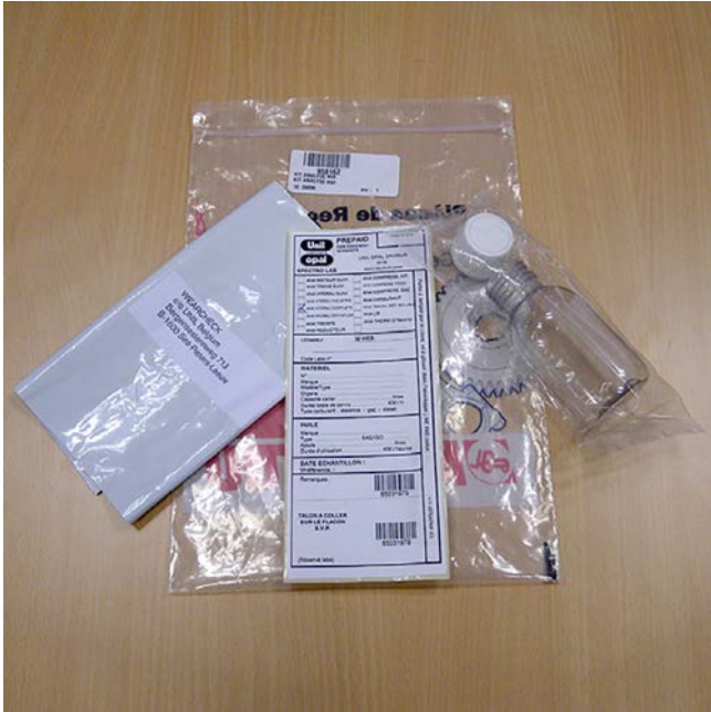
Figura 165: Verificarea contaminării uleiului hidraulic
