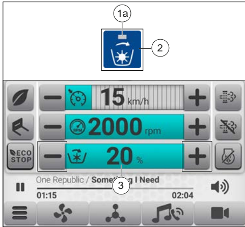
Figura 123: Mișcare hidraulică continuă a accesoriului
