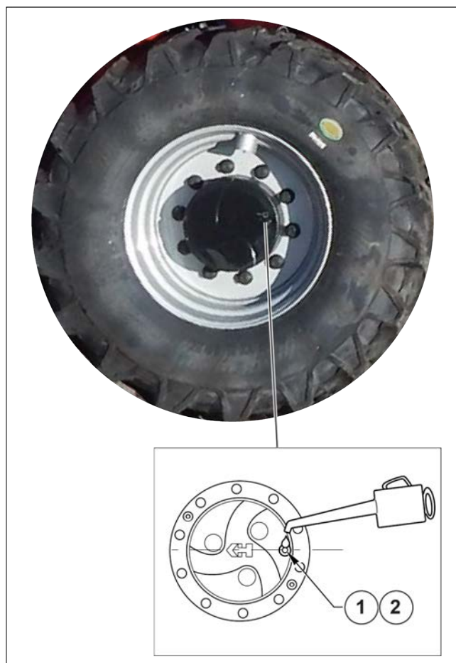
Figura 156: Verificarea nivelului de ulei pentru reductorul roților față și spate
