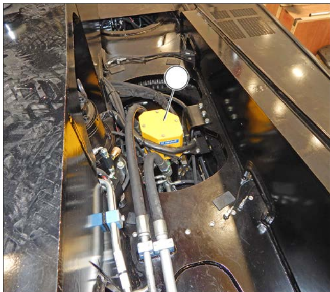
Figura 208: Verificarea și curățarea inelelor emițătorului pentru colectorul electric rotativ
